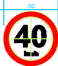
R - 19 (Velocidade Máxima Permitida) SEMI REFLETIVAS Letras: Série D ou E (M), centralizados. Fundo: Branco Orla: vermelho Letra, Algarismo e Símbolo: Preto - Fonte Arial Verso: Preto Fosco
