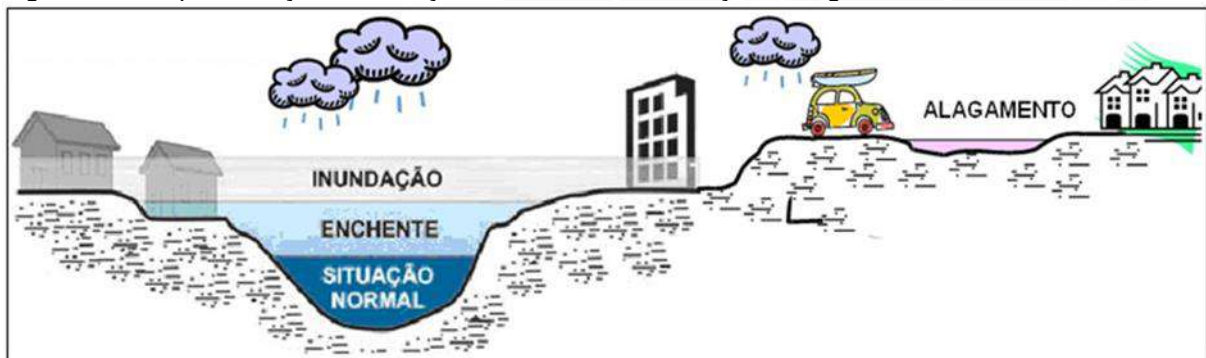
Figura 124: Representação de situação de enchente, inundação e alagamento.
