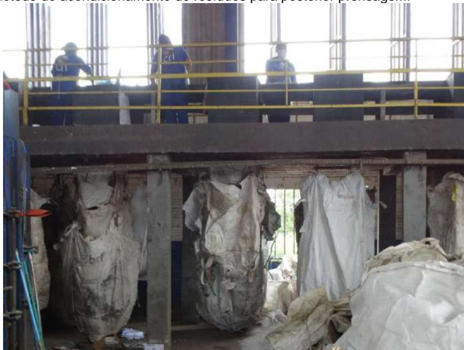
Figura 87: Método de acondicionamento de resíduos para posterior prensagem.
