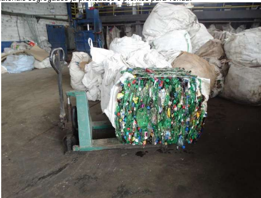
Figura 89: Materiais segregados já prensados e prontos para venda.
