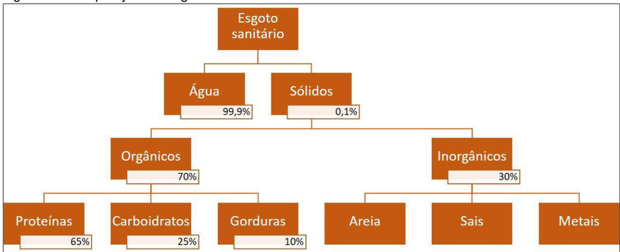
Figura 61: Composição do Esgoto Sanitário
