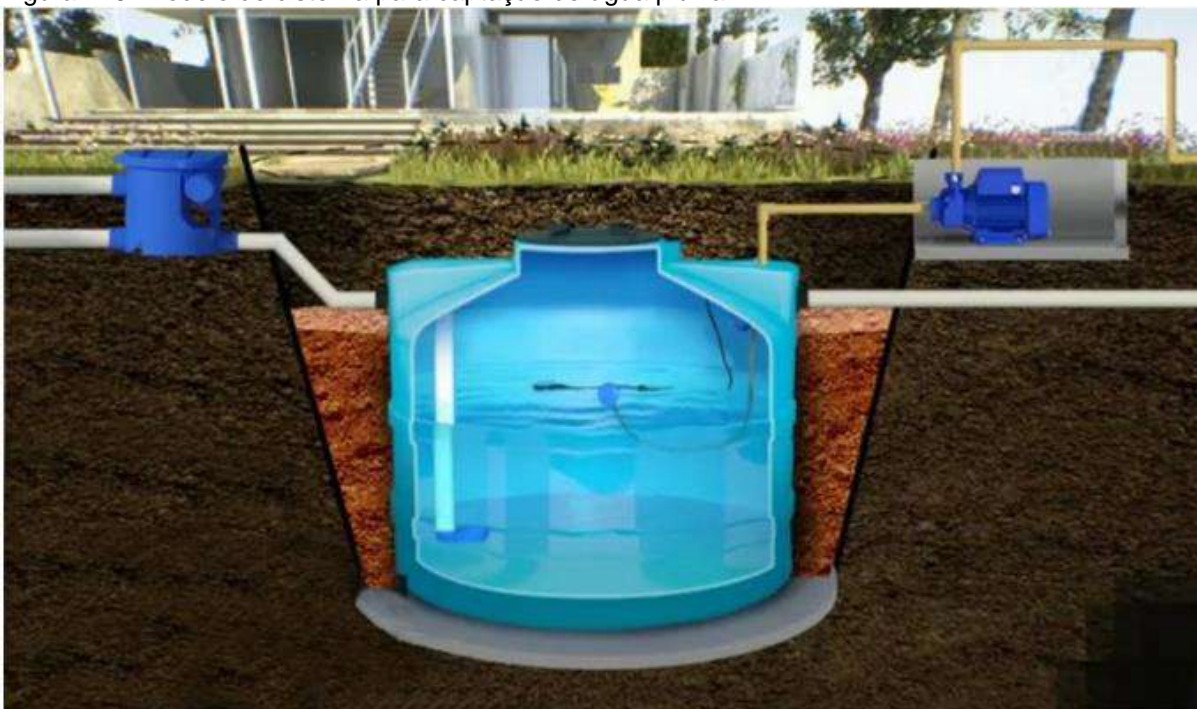
Figura 175: Modelo de cisterna para captação de água pluvial.
